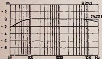
Figuur 6: Maximum uitgangsvermogen voor 2½% vervorming (0 dB = 7 watt)
